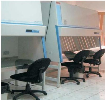
Cámaras de flujo laminar, para manipular el material vegetativo en condiciones asépticas.
