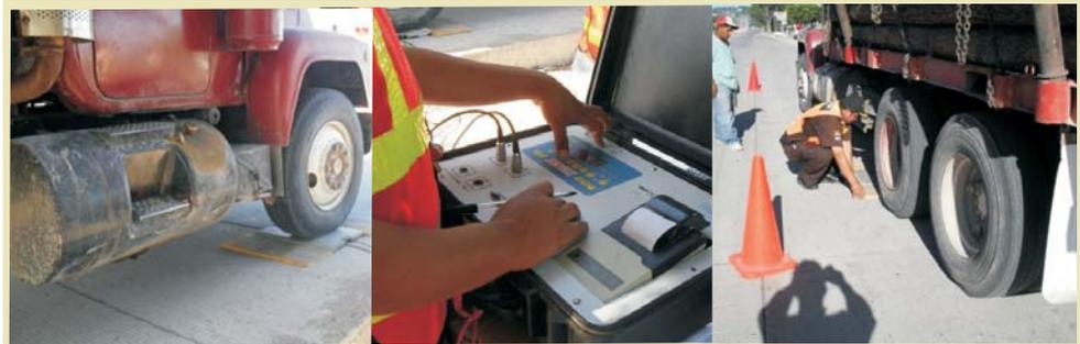
El censo se efectuó a través de básculas conectadas a una computadora con un cable que envía el peso de cada eje.
