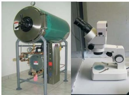
Una autoclave cilíndrica y modernos estereoscopios son parte del equipo.
